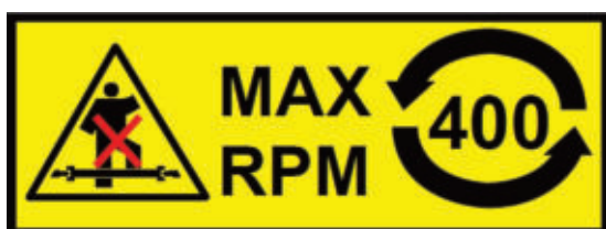
Óvakodjon a forgó tengelytől! A TLT-tengely maximálisan megengedett forgási fordulatszáma és forgásiránya.
